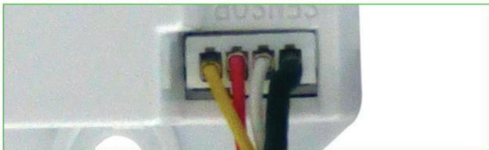
Bornas para la conexión del cableado.
